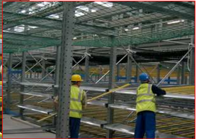
TRAVIROLL® : dynamische stockage op basis van TRAVIRACK® paletrekken.
