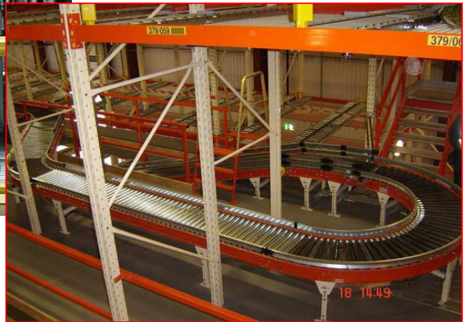
TRAVIROLL® : dynamische stockage op basis van TRAVIRACK® paletrekken.
