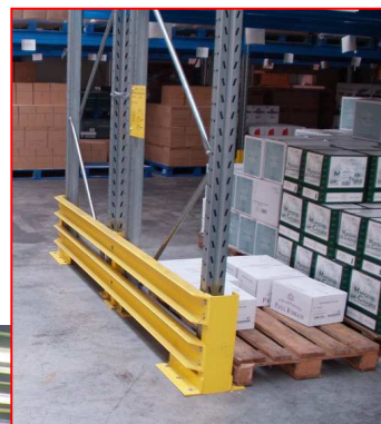
Protections de montants & d'échelles.
