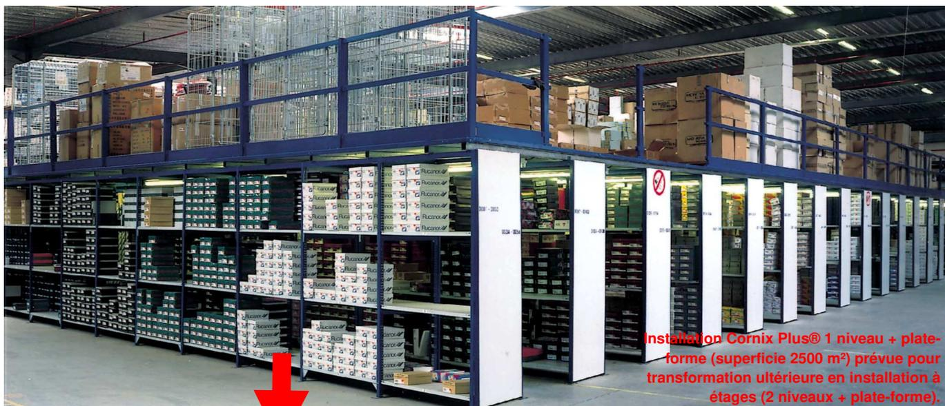
Installation Cornix Plus® 1 niveau + plate-forme (superficie 2500 m<sup>2</sup>) prévue pour transformation ultérieure en installation à étages (2 niveaux + plate-forme).
