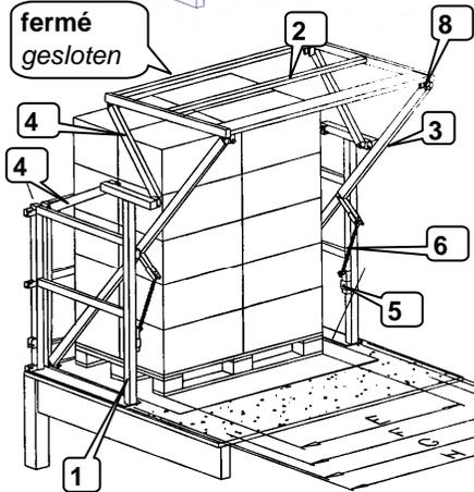
Montez les biellettes de commande (3) avec 2 vis épaulée sur les supports d'articulation (1).
