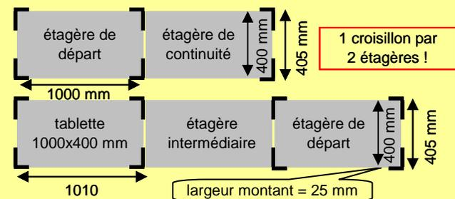
profondeur totale : profondeur tablette (p.e. 400 mm) + 5 mm
