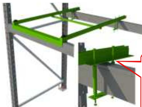
4x M8x150 pour une hauteur longeron maximale 127 mm.
